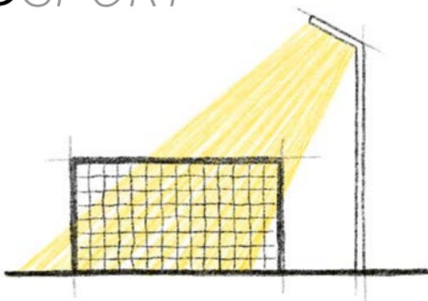
Sportplatzbeleuchtungen mit asymmetrischen und dimmbaren LED-Strahlern verbrauchen weniger Strom und bieten mehr Qualität als herkömmliche Anlagen mit Halogen-Metaldampf-Lampen. Zur Erreichung der notwendigen Beleuchtungsstärke braucht es keine Vorlaufzeit mehr.
